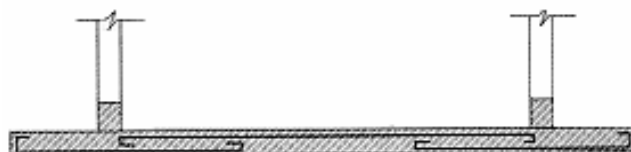
disposição da armadura
